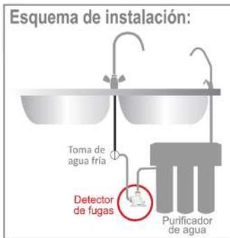
En caso de pérdidas de agua, el detector de fugas corta automáticamente el agua evitando daños en su vivienda.
