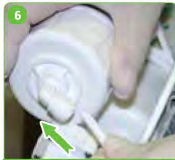
6 CONECTAR EL TUBO DE LA TAPA DEL PORTAMEMBRANAS
