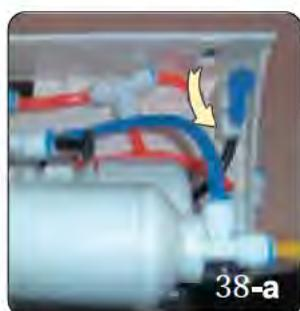
Siempre que utilice por primera vez este equipo o cuando sustituya los filtros, con el fin de no perjudicar la membrana con restos de carbón, debe situar el mando de la VÁLVULA DE FLUSING en la posición que muestra la foto (38-a) durante unos 10' aproximadamente. De este modo se procede al lavado de los filtros.
