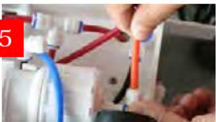
COGER EL TUBO NARANJA DEL EQUIPO DE PRESIÓN E INSERTARLO A LA ENTRADA DEL PORTAMEMBRANAS (DONDE ANTES ESTABA EL TUBO ROJO)
