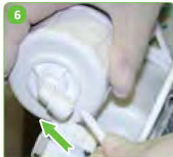
CONECTAR EL TUBO DE LA TAPA DEL PORTAMEMBRANAS
