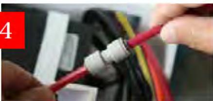
INSERTAR EL TUBO ROJO QUE HEMOS DESCONECTADO DEL PORTAMEMBRANAS Y ACOPLARLO AL ENLACE RÁPIDO.
