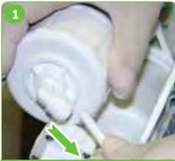
1 DESCONECTAR EL TUBO DE LA TAPA DEL PORTAMEMBRANAS
